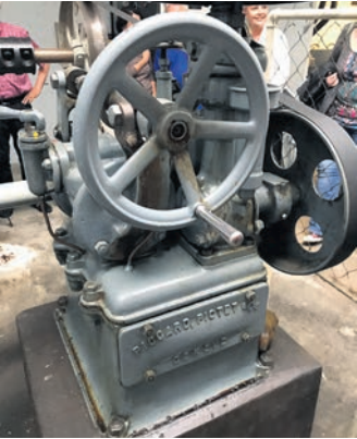
Turbine hydraulique (régulateur de régime) Piccard-Pictet et Cie construite à Genève.
